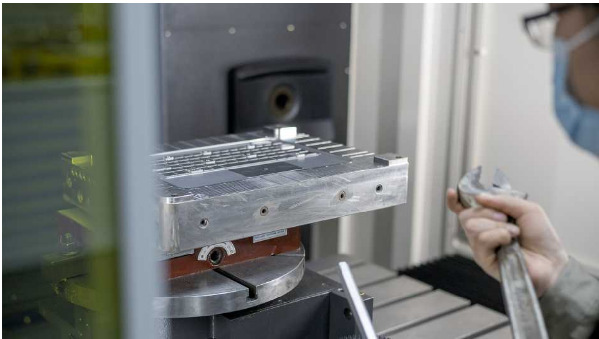
Einlegen eines Laptop-Formwerkzeugs auf den Maschinentisch der AgieCharmilles Laser S 1000 U. Anschliessend startet der Laserprozess.
